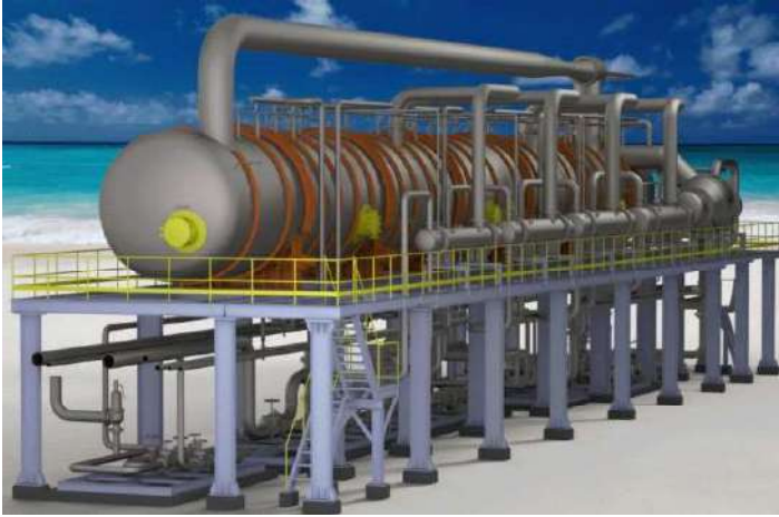
MED – TVC Desalination Plant BARC, Mumbai
